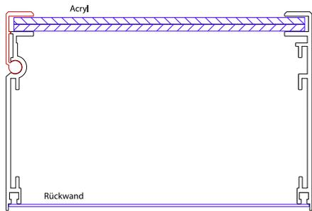
Klapprahmen **88 mm** mit Klappe **12 mm**
